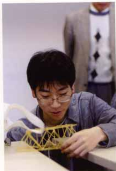
パスタ橋の強度試験
